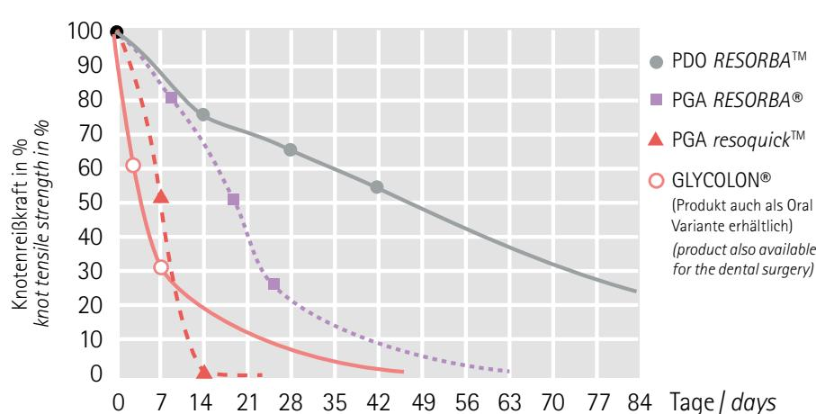
In-vitro-Degradationsversuch: Messung der Knotenreißkraft von GLYCOLON®, PGA resoquick™, PGA RESORBA® und PDO RESORBA™. Nahtmaterial der Stärke 3-0 USP bzw. 2 metric.
